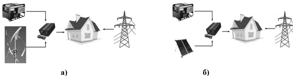
Рис. 12.1. Варианты комбинированных автономных энергетических установок: а) дизель-ветровая автономная энергоустановка, б) дизель-фотоэлектрическая автономная энергоустановка (Источник: составлено автором)
